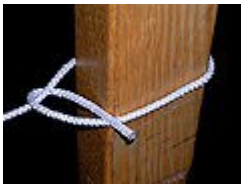
Step 1: Forme un medio cote o nudo simple
